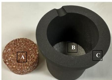
Figure 1. ORB bath assembly: A) ORB, B) bath, C) crucible.
